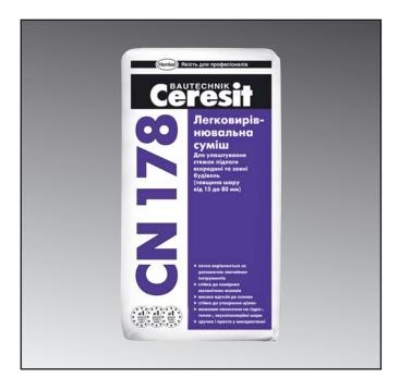
и заделываются растворной смесью Ceresit CN 178. При толщине слоя стяжки от 15 до 40 мм основание необходимо загрунтовать полностью. При толщине слоя свыше 40 мм основание очищается от веществ, уменьшающих адгезию, и увлажняется, после чего укладывается слой Ceresit CN 178. При устройстве плавающих стяжек на разделительном слое толщина слоя должна быть не менее 40 мм.
