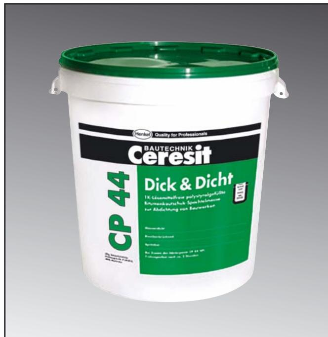
При воздействии напорной воды гидроизоляционный слой мастики необходимо усилить полиэфирной тканью. Для этого наносится слой мастики толщиной около 2 мм, в него слегка вдавливается ткань, а затем наносится еще один слой до получения общей требуемой толщины. Материал применяется со стороны воздействия воды.
