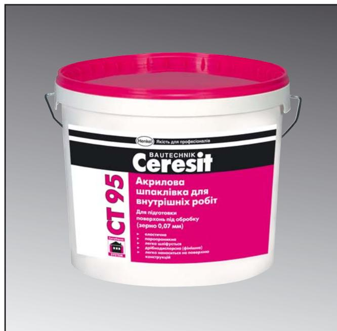
Шпаклевка наносится на поверхность до получения необходимой толщины несколькими слоями, толщина одного слоя не должна превышать 1,0–1,5 мм. Максимальная толщина шпаклевочного слоя не должна превышать 3 мм. В период высыхания шпаклевки ее нельзя сбрызгивать водой. Не высохший излишек материала на инструменте или подготовленной поверхности можно смыть водой. Затвердевшую шпаклевку можно удалить только механическим путем.
